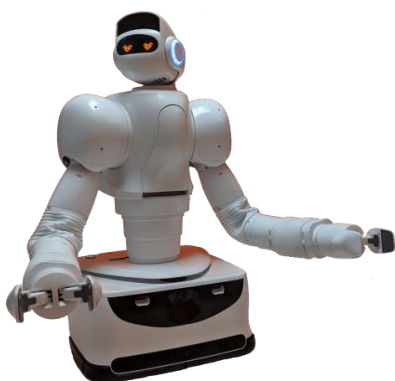
次世代を見据えた「AI対応ロボット」。介護現場では洗濯物の集配、配膳や食器の運搬、下膳、片付け、排泄や廃棄物の処理などの支援が考えられる。AIを搭載し人や物の検知、認識などを行う。利用者の異常事態を認識して通知する機能もある。↓
