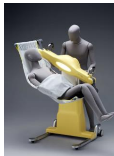
←被介護者に無理をさせることなくロボット⇄車椅子の移乗に対応する「SASUKE」。ADLの低下や体重過多で2人介助が必要な方にも対応出来る移乗介助用ロボット。
