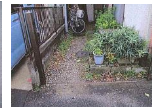
BEFORE <玄関アプローチの舗装> AFTER 歩幅にあわせた庭石等は車いすの走行に不向きです、玄関から道路・駐車場まで舗装すると走行がスムーズになります。
